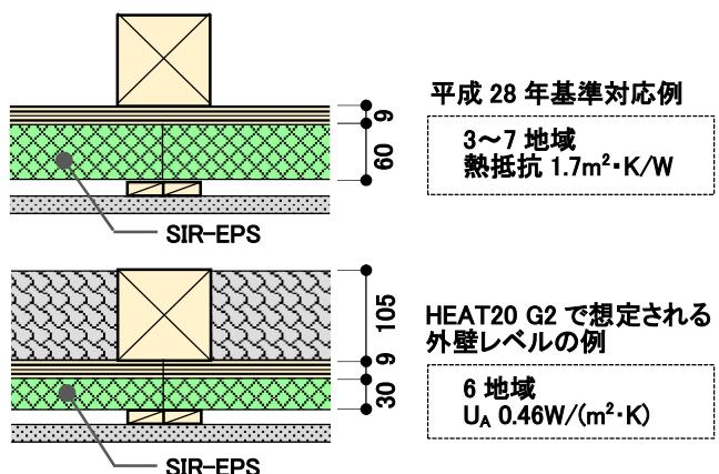
通常の外張断熱工法と同じ断熱性能を得ることができます。充てん断熱を併用すれば HEAT20 G2 や ZEH レベルの外壁の断熱性能とすることも可能です。
